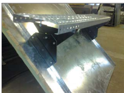
popis 1 Podpěra roštu č. 79 používaná jen na drážkové krytiny s nosností 120 kg při rozpětí 100 cm
