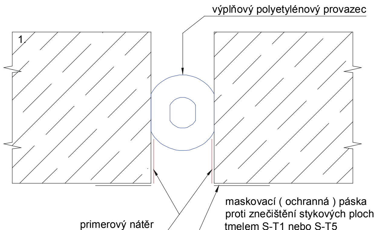
Obr.1 Spára připravená k těsnění
